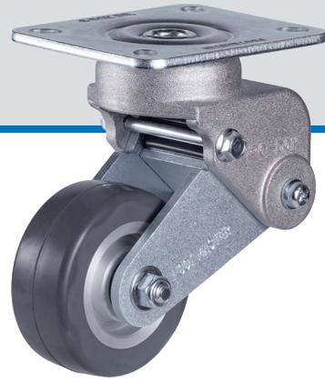
**产品说明:** 冲压脚轮座，使用强化热处理的双重钢珠槽旋转结构，铝制壳体，使用耐热性特殊橡胶的微小冲击吸收功能，采用特殊形状的轮轴强化柔和旋转性，最高250°C可适用
