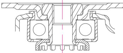
**产品说明:** 冲压脚轮座，使用精密球轴承，耐久性突出，旋转柔和的旋转结构，一体化冲压支架，螺栓式轮轴紧固构造，使用耐热性特制润滑油
