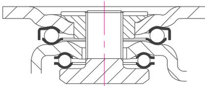
**Brackets:** 프레스 플레이트, 강화열처리 시트가 4장이 적용된 내구성이 뛰어나고 빠른 회전에 강한 회전구조, 일체화된 강력한 프레스 프레임, 부드러운 탭브레이크 시스템, 볼트너트식 샤프트 체결구조
