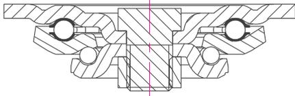
**Brackets:** 프레스 플레이트, 강화열처리 시트가 적용된 이중 볼 회전구조, 그리스 니플 적용, 강력한 용접 프레임, 부드러운 사이드 브레이크 시스템, 볼트너트식 샤프트 체결구조
