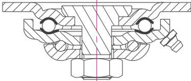
**Brackets:** 프레스 플레이트, 강화열처리 시트가 적용된 이중 볼 회전구조, 그리스 니플 적용, 강력한 용접 프레임, 부드러운 사이드 브레이크 시스템 (200시리즈: 탑브레이크), 볼트너트식 샤프트 체결구조
