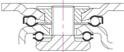
**Brackets:** 프레스 플레이트, 강화열처리 시트가 4장이 적용된 내구성이 뛰어나고 빠른 회전에 강한 회전구조, 일체화된 강력한 프레스 프레임, 부드러운 탑브레이크 시스템, 볼트너트식 샤프트 체결구조
