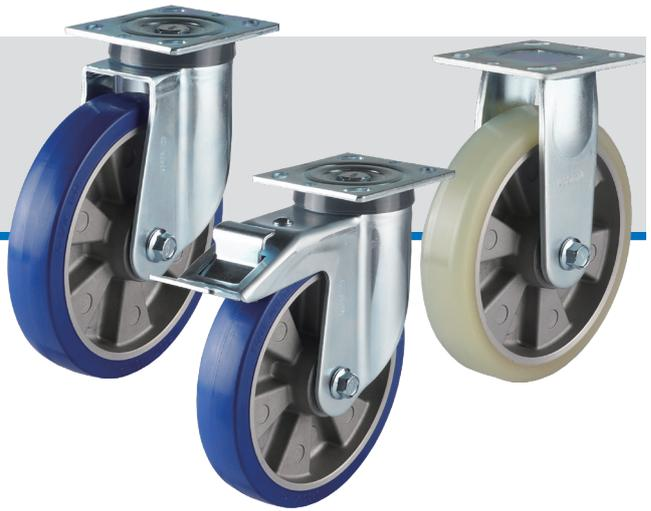
Brackets: 프레스 플레이트, 강화열처리 시트가 적용된 이중 볼 회전구조, 일체화된 강력한 프레스 프레임, 휠 및 선회부의 잠금기능이 동시에 작동하는 토달락 스틸 탑브레이크 시스템, 볼트너트식 샤프트 체결구조
