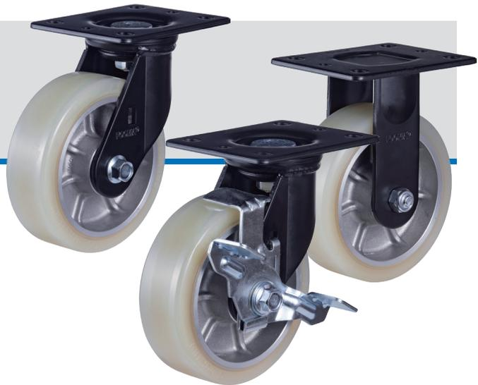
**Brackets:** 프레스 플레이트, 강화열처리 시트가 적용된 이중 볼 회전구조, 그리스 니플 적용, 강력한 용접 프레임, 부드러운 사이드 브레이크 시스템, 볼트너트식 샤프트 체결구조
