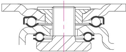
**Brackets:** 프레스 플레이트, 강화열처리 시트가 4장이 적용된 내구성이 뛰어나고 빠른 회전에 강한 회전구조, 일체화된 강력한 프레스 프레임(200 시리즈: 용접 프레임), 부드러운 탑브레이크 시스템, 볼트너트식 샤프트 체결구조
