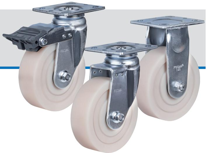
**Brackets:** 프레스 플레이트, 강화열처리 시트가 4장이 적용된 내구성이 뛰어나고 빠른 회전에 강한 회전구조, 일체화된 강력한 프레스 프레임(200 시리즈: 용접 프레임), 부드러운 탑브레이크 시스템, 볼트너트식 샤프트 체결구조
